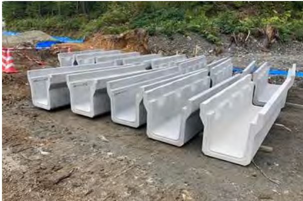
成瀬ダム付替道路で実証を行ったCO 2 を固定したコンクリート（U字溝）
