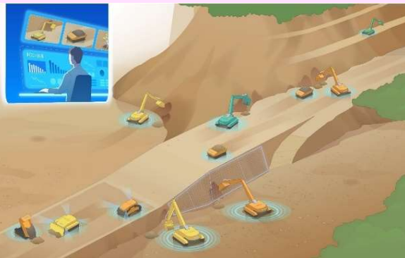
自動化建設機械による施工
